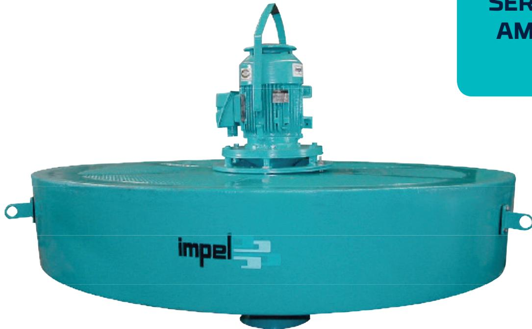
Aereadores Mecánicos Flotantes de alta velocidad fabricados con cuerpo de hierro nodular ó acero inoxidable y unidad de flotación con estructura interior de acero al carbón, relleno de espuma de poliuretano de alta densidad y cubierta de fibra de vidrio.
